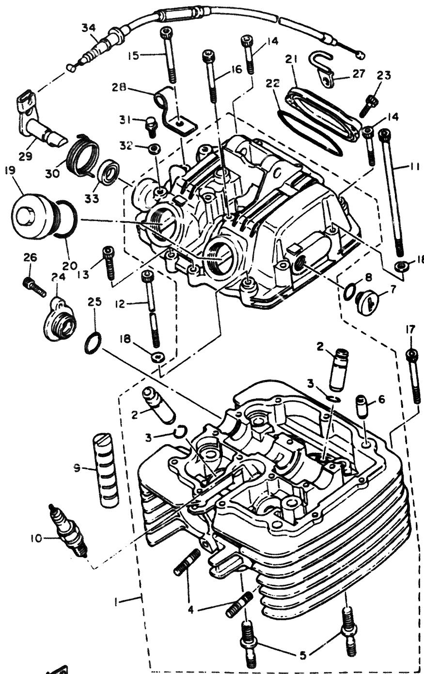
FIG. 1 CYLINDER HEAD
